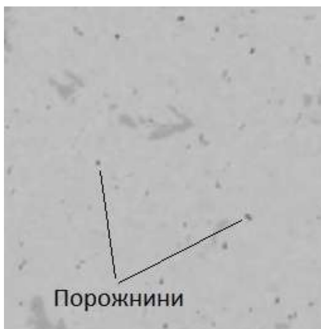
Рис. 4.9 SEM зображення пористої мікроструктури сплаву SAC305 з вуглецевими нанотрубками
