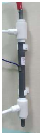
Рис. 7.1 Електрохімічна комірка з коаксіальним розташуванням электродів
