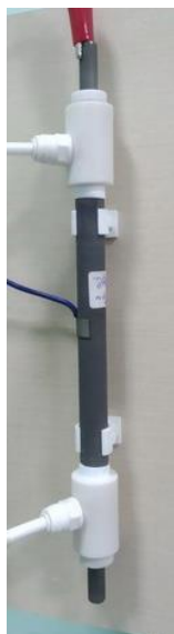
Рис. 27. Електрохімічна комірка з коаксіальним розташуванням електродів
