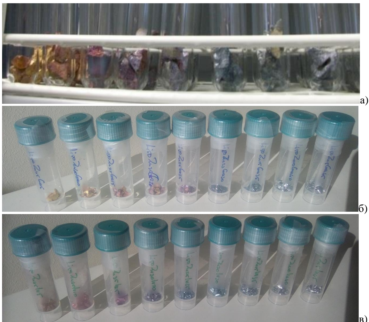
Рис. 7.2. Серії кольорових сплавів на перетинах \text{Li}(\text{Zn}_x\text{Al}_{1-x}) (а), та \text{Li}(\text{Zn}_x\text{Ga}_{1-x}) (б) та \text{Li}(\text{Zn}_x\text{In}_{1-x}) (в) з табл. 7.2
