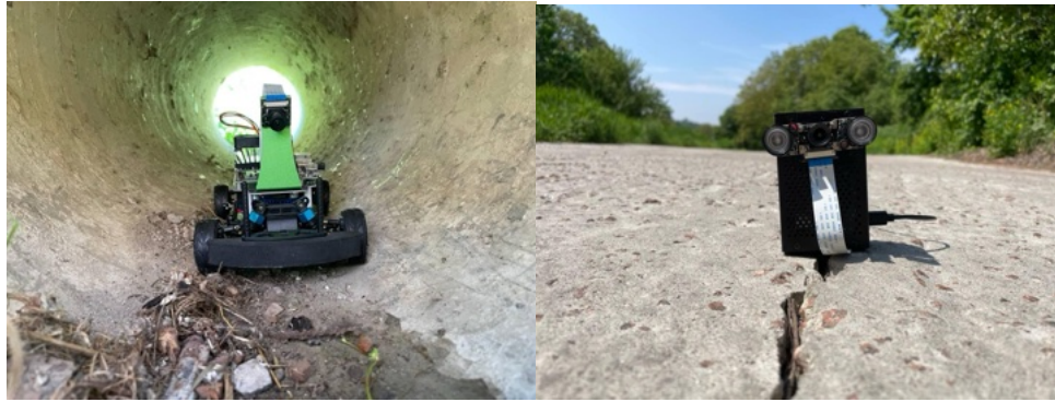
Рис. 3.4. Засоби для розпізнавання дефектів на основі мікрокомп'ютерів Nvidia Jetson Nano та Raspberry Pi
